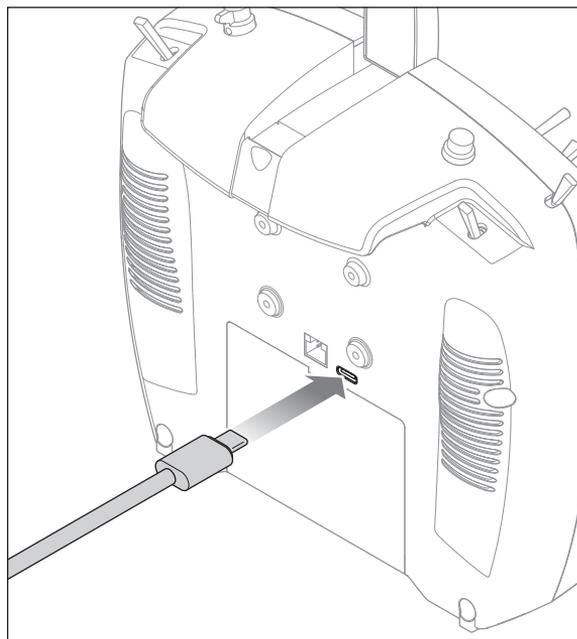
5. La charge est terminée lorsque la DEL et les barres à DEL s'éteignent, que le bouton est enfoncé et que l'icône de capacité de la batterie s'affiche complet sur l'écran. Débranchez le câble USB de l'émetteur une fois la charge terminée. Débranchez l'alimentation électrique de la prise électrique.
