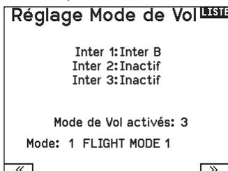
Vous pouvez assigner jusqu'à dix modes de vol en utilisant n'importe quelle combinaison de jusqu'à trois commutateurs. Le nombre maximum de modes de vol et de commutateurs disponibles dépend du type de modèle.
