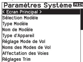
Vous pouvez également accéder au menu des Paramètres Système sans devoir mettre l'émetteur hors tension. Un écran d'alerte apparaît vous indiquant que la liaison radio RF sera interrompue (le signal venant de l'émetteur sera désactivé). Sélectionnez OUI si vous êtes sûr de vouloir accéder au menu des Paramètres Système. Si ce n'est pas le cas, appuyez sur NON pour revenir à l'écran principal et continuer l'utilisation courante.
