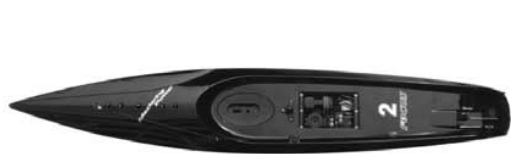
Coque équipée du servo treuil et du servo de safran
