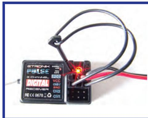
**Quand la procédure de Bind est terminée vous pouvez configurer la position de sécurité en enfonçant le bouton Failsafe avec le pointeur.**
