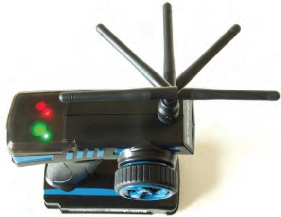
L'antenne se plie pour un meilleur stockage. Mais elle se déplie et est positionnable pour maximiser la portée de la radio
