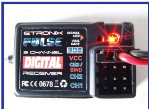
**Sauf si votre modèle possède un variateur avec BEC alimentez votre récepteur par la voie 2. Si c'est pack de récepteur qui alimente le récepteur, il doit être branché dans la prise VCC en prenant soin de vérifier la polarité.**
