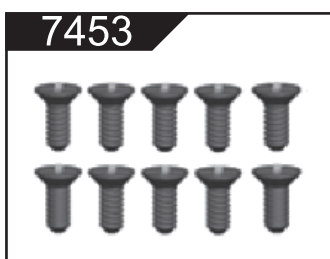
7453 Senkkopfschneidschrauben 2.6x8 (10)
