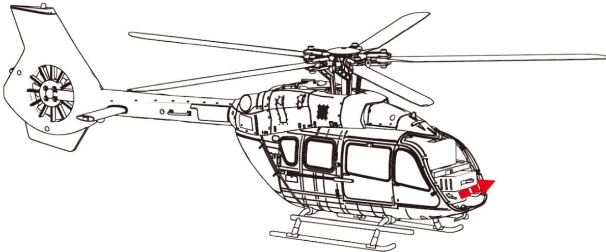
Verriegeln Sie den Akku über den Schiebeschalter um, ein herausfallen des Akkus zu vermeiden.
