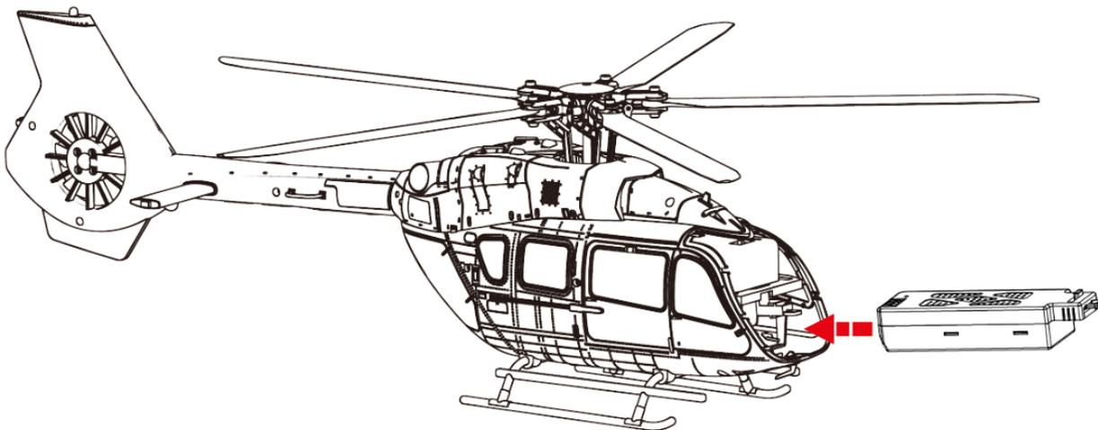
Öffnen Sie das Cockpit und schieben Sie den Akku in den Akkuschlacht.
